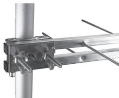
Закрепить антенну на мачту с помощью кронштейна и барашковых гаек.
