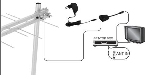
Подключите адаптер питания и антенный кабель к усилителю с одной стороны, а усилитель подключите к ТВ или ресиверу.
