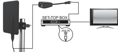
Подключите кабель от антенны к усилителю сигнала (или ресиверу), а усилитель (или ресивер) соедините с ТВ.
